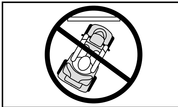
Abb. 3A. Falsches Anfahren einer Bordsteinkante
